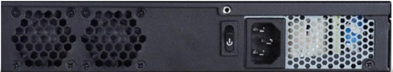
Assim como computadores ATX, o ServerU pode iniciar o processo de desligamento simplesmente com um clique nesse botão. Se o sistema travar, por alguma razão, pressionar o botão “Power” por mais de 5 segundos irá desligar o ServerU de forma forçada.
